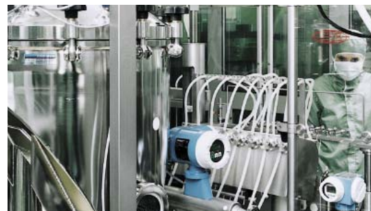
Medida de caudal másico mediante el caudalímetro Promass Coriolis.
