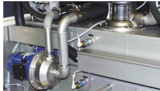
Protección de la bomba mediante detectores de nivel Liquiphant.
